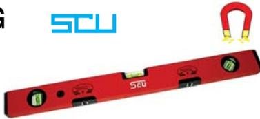
Piano magnetico, con due potenti calamite. Con 3 bolle infrangibili e impermeabili, orizzontale, verticale e inclinata di 45°. Precisione mm 1 per metro (0,057°).
