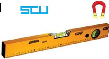
Piano magnetico, con due potenti calamite. Bolla centrale regolabile e intercambiabile. Con 2 bolle infrangibili e impermeabili, orizzontale e verticale. Base graduata in millimetri eccetto misure mm 1200 - 1500. Verniciata gialla. Precisione mm 0,5 per metro (0,029°).
